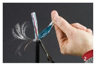
Mit einem Messer die äußere Isolationsschicht des Kabels bei 5-6 cm einschneiden und abziehen. Trennen Sie mit einer kleinen Schere das Abschirmgeflecht und die äußere Aluminiumfolie komplett ab. Achten Sie bitte darauf, dass der Kupfer - Massedraht nicht beschädigt wird. Biegen Sie diesen nach unten.
