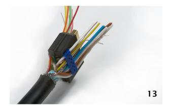
Überprüfen Sie noch einmal, ob die Schneidklemmführungen soweit wie möglich nach unten geschoben sind und exakt ineinander passen (Siehe Bild 10). Legen Sie jetzt die Schneidklemmführungen in die Montageführung ein. Blau kommt auf die gerade, Türkis auf die abgeschrägte Seite des HDMI Steckverbinders.
